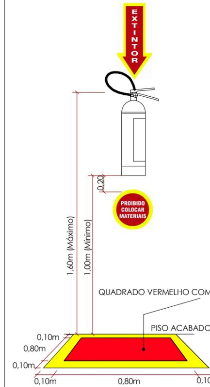
**DETALHES DE INSTALAÇÃO DO EXTINTOR DE COLUNA**
