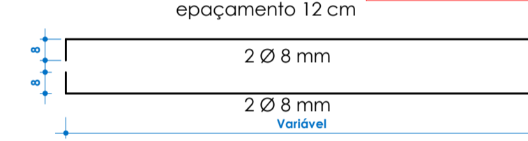
P1=P3=P4 S1=S3=S4 70 64 7 Ø 8 mm 8 4 Ø 5 mm espaçamento 12 cm
